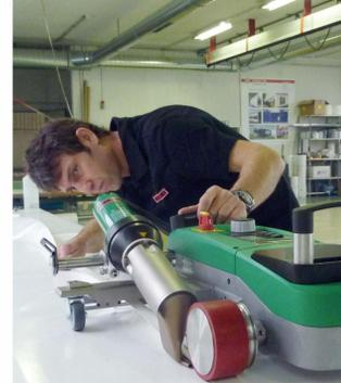
Простая сварка с подворотом и кедером при использовании специального комплекта
