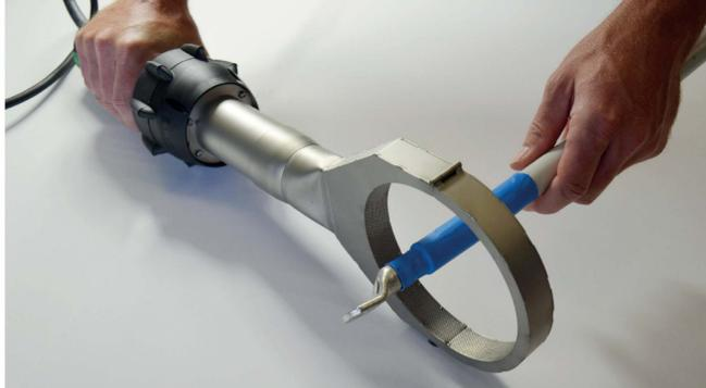
Процесс термоусадки при помощи аппарата ELECTRON ST
