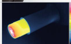
**Удобно:** защитная трубка с активным охлаждением для повышенной эксплуатационной надёжности.
