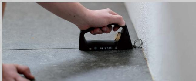
Благодаря направляющим роликам обеспечивается точный рез
