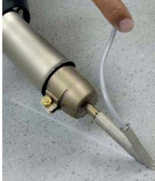
Сварка напольных покрытий ручным аппаратом TRIAC ST
