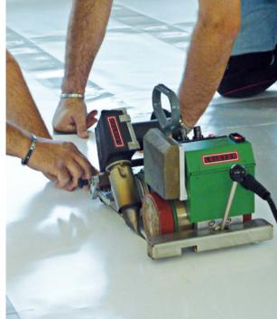
Удобный инструмент для точной сварки — UNIPLAN E
