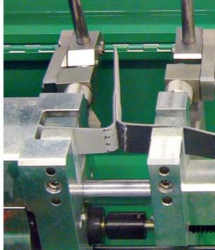
Испытание сварного шва при помощи EXAMO USB
