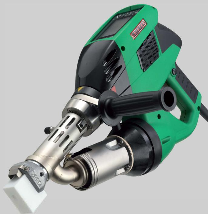
Экструдер WELDPLAST S2 применяется в различных климатических условиях и труднодоступных местах, обладает производительностью до 2,3 кг/ч. Используется для сварки конструкций из листового полиэтилена и полипропилена, гидроизоляции, ПЭ изоляции ППУ труб, безнапорных трубопроводов.
