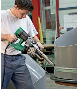
Экструдер FUSION 3C при сварке резервуара
