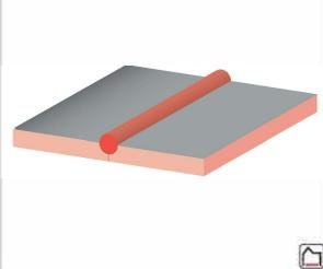
Стыковая сварка V-образный шов
